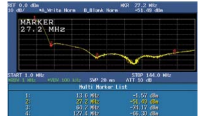
Bild 7: Frequenzgang des Tiefpassfilters (Tracking Generator + Spektrumanalysator)
