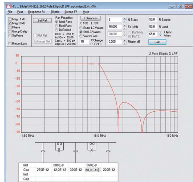
Bild 5: Frequenzgang des elliptischer Tiefpassfilters mit Schaltung
