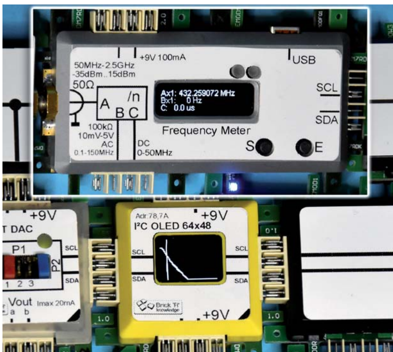
Bild 9: OLED mit Marker und Frequenzanzeige eingeblendet für den Tiefpassfilter
